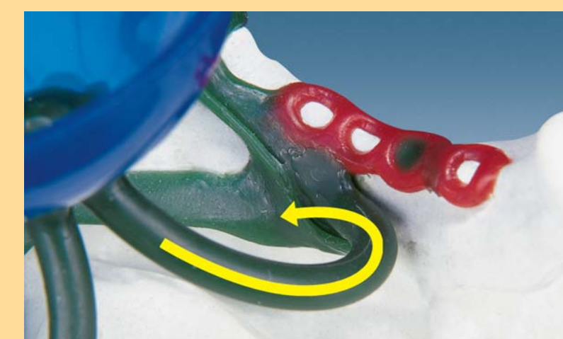
Установка литников к самому толстому месту моделировки
